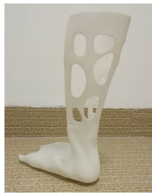
图8 材料Somos® NeXt打印的AFO
